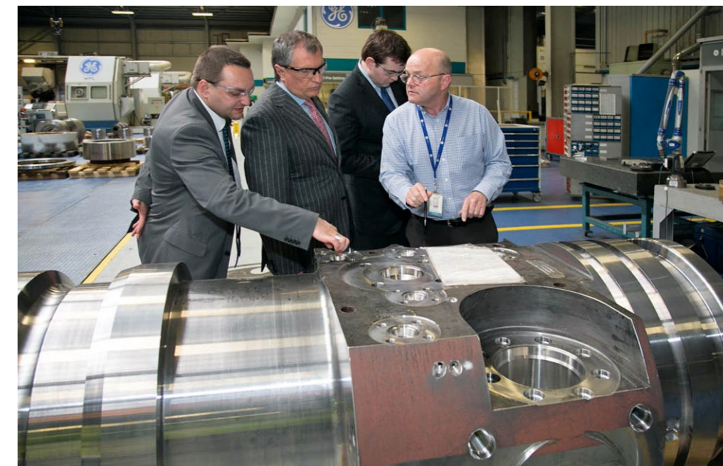
Специалисты General Electric демонстрируют составные части подводной фонтанной арматуры для оборудования морской скважины. Оборудование предназначено для обеспечения герметизации морских скважин
